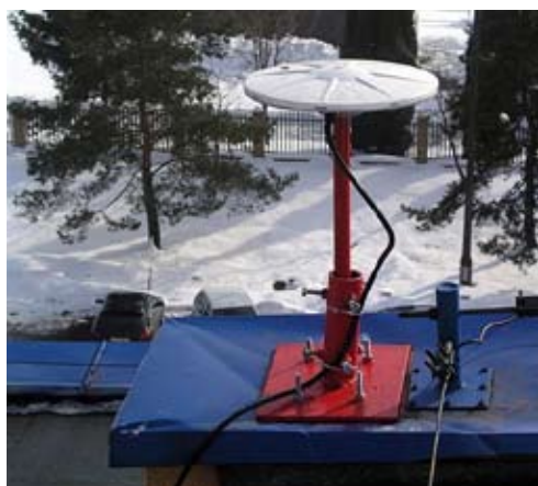
Rys. 4. Antena stacji referencyjnej GPS, na dachu budynku cechowni Figure 4. Reference station GPS antenna on the roof of the cechownia building
