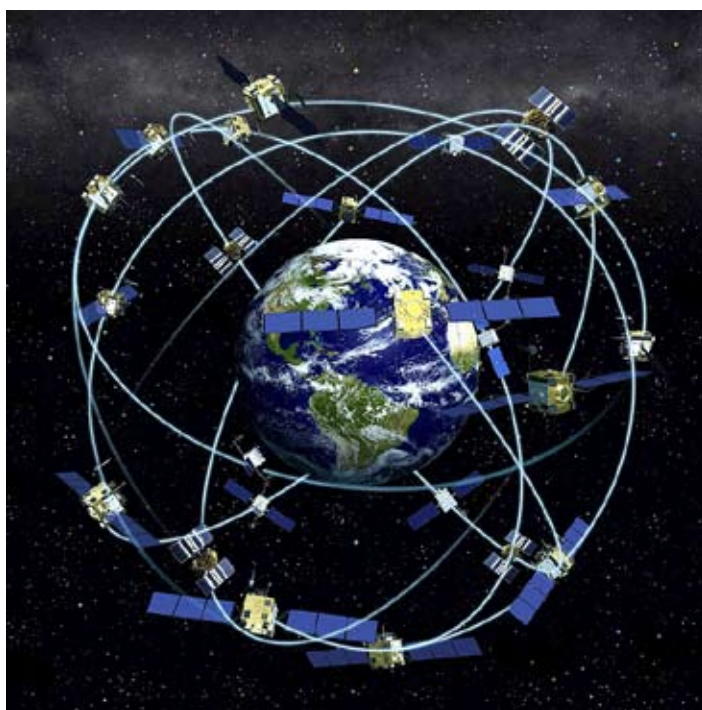
Rys. 1. Układ satelitów GPS (syst. amerykański, 6 orbit co 600 dł. geograficznej po 4 satelity na każdej orbicie). Śr. odl. satelitów od pow. Ziemi 20 200 km. Nachylenie orbit do płaszczyzny równika: 55°. Czas obiegu: 11h 57min 27s. Syst. amerykański GPS, w pełnej konfiguracji działa nieprzerwanie i bezawaryjnie od 17 lat
