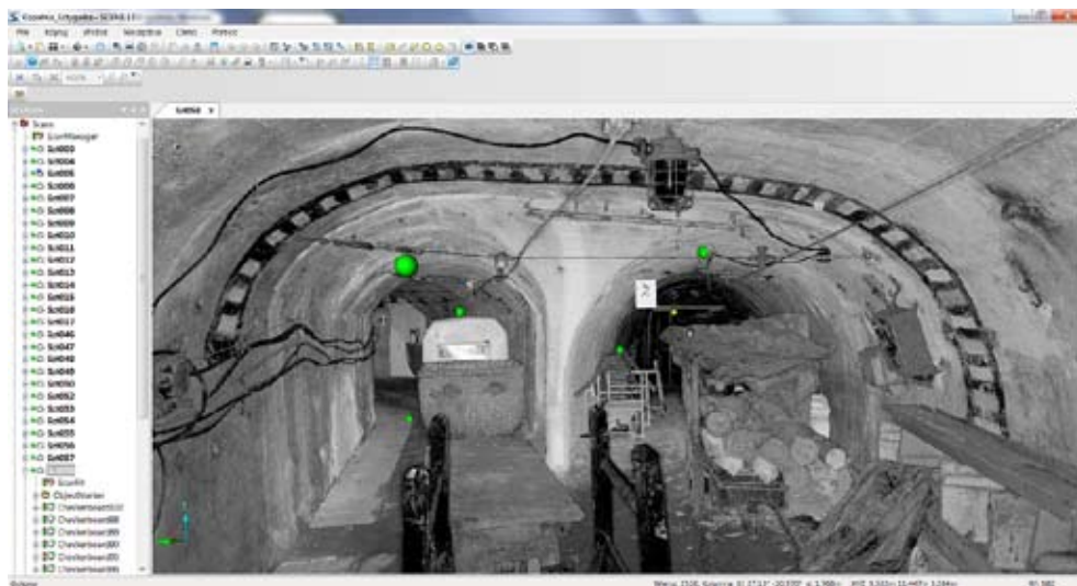
Rys. 1. Skan części wyrobiska widoczny w odcieniach szarości
